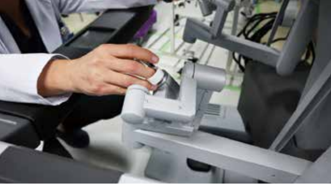
サージョンコンソール側の医師はハイビジョン 3D 画像で手術部位を観察（左）。ペイシェントカートのロボットアーム先端についた鉗子を手で操作。きわめて繊細な動きが可能（下）。
