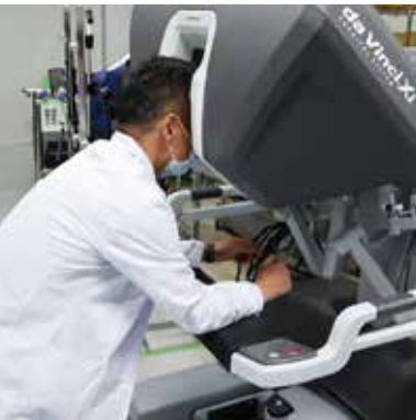
サージョンコンソール側の医師はハイビジョン 3D 画像で手術部位を観察（左）。ペイシェントカートのロボットアーム先端についた鉗子を手で操作。きわめて繊細な動きが可能（下）。
