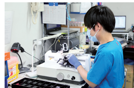
組織を「包埋」したパラフィンブロックを「薄切」する臨床検査技師。数μm程度の薄さにまで削いでいく
